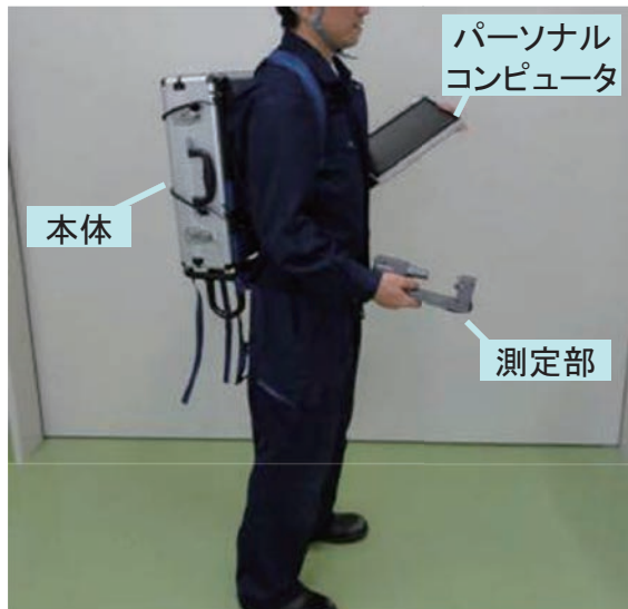
図3 開発した振動測定装置の概観写真
