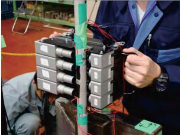
図9 標準LED式非接触振動測定法の振動応力測定装置による測定デモ
