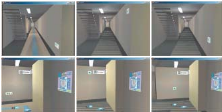
図6 各設置方法における通路避難誘導灯の設置例 （左から設置方法A, B, C. 上段から場面5-2, 7）
