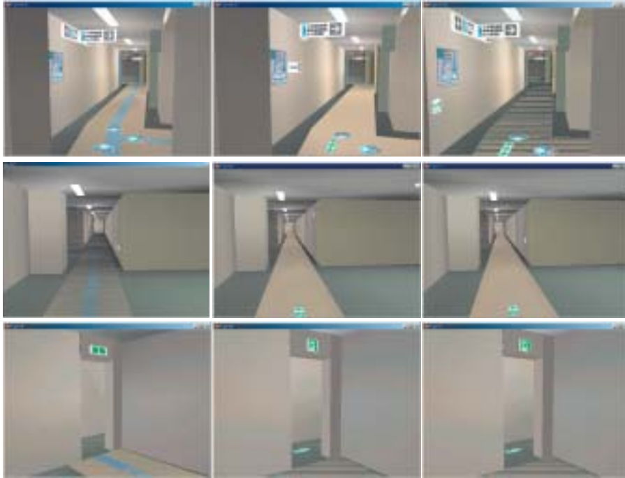
図4 各設置方法における床面避難誘導表示の設置状況の例 (左から、設置方法A, B, C. 上段から場面3, 5-1, 8)
