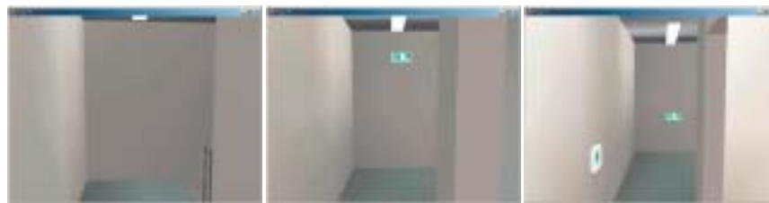
図5 階段室に設置された避難誘導表示（場面9） 左から、設置条件A, B, C
