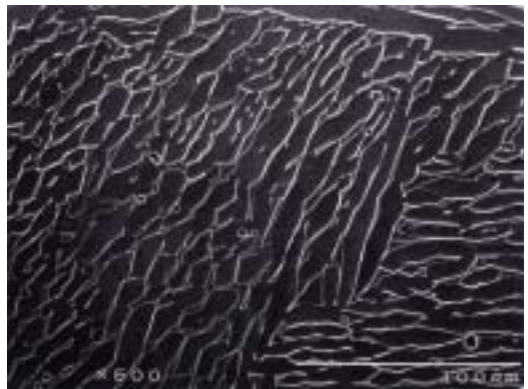
図4 4元モデル合金材Mo5のSEM観察
