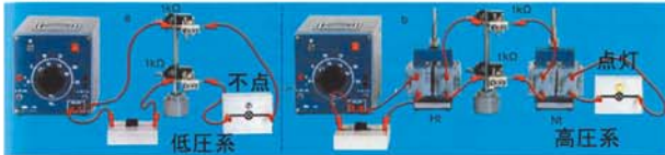
Abb. 4: Übertragung elektrischer Energie: a) unwirtschaftlich mit Niederspannung, b) wirtschaftlich mit Hochspannung
