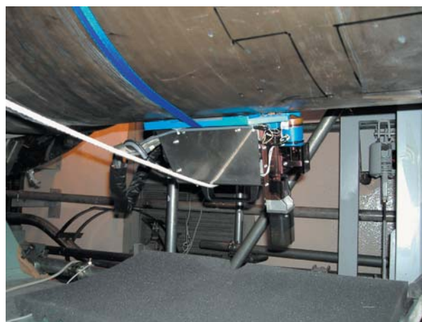
図6 測定装置（測定部）の取付例（180°付近）
