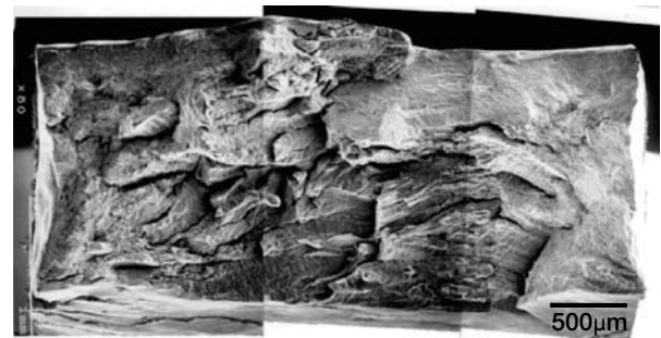
(b) 132 合金材の SSRT 試験後破面 (破断時間：48.93h, 粒界破面率：72.4%)
