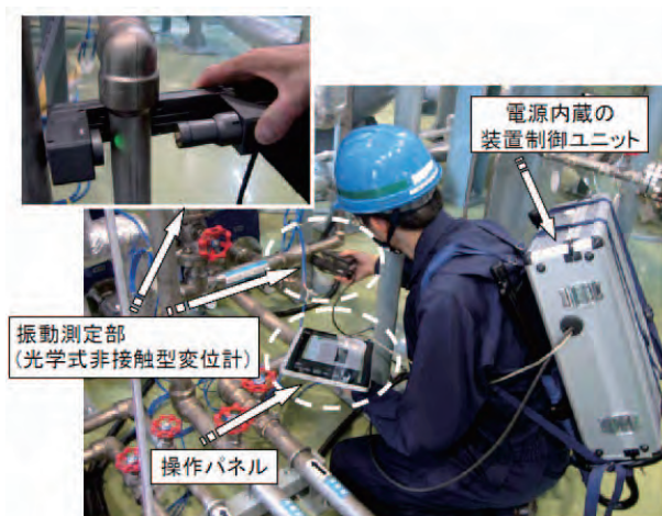
図5 開発した配管振動応力の非接触計測装置と現場計測のイメージ
